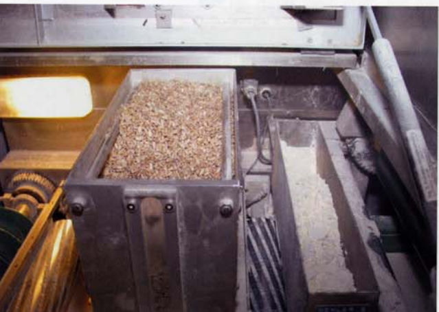
Die Anlage erlaubt es, grobe Körner oder Käse vor dem Schneidvorgang auf das Teigband aufzubringen.
