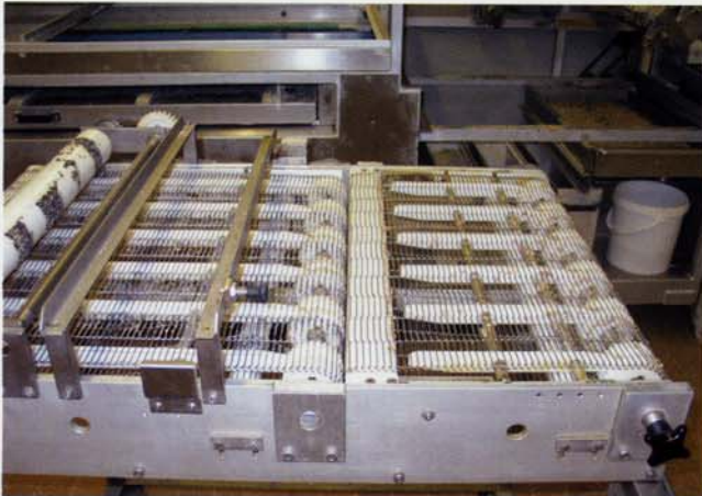
Das Gitterband der Bestreueinheit kann zur Reinigung entnommen werden.
