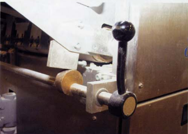
Mittels eines Hebels lassen sich die Spreizbänder hochstellen. So ist es möglich Teiglinge beidseitig zu bestreuen.
